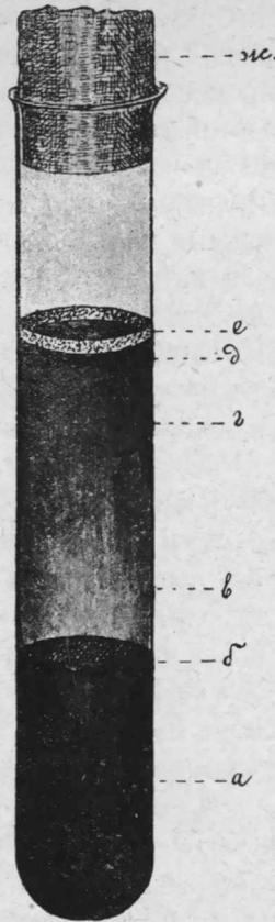
Рис. 3. *a* — образецъ грунта; *b* — черный слой, образовавшійся на поверхности образца грунта; *v* — вода, принявшая черноватый оттѣнокъ; *d* — пленка на поверхности воды; *e* — кольцеобразный, желтовато-краснаго цвѣта, налетъ на стѣнкахъ пробирки; *ж* — пробка изъ ваты. Описание опыта см. стр. 19.
